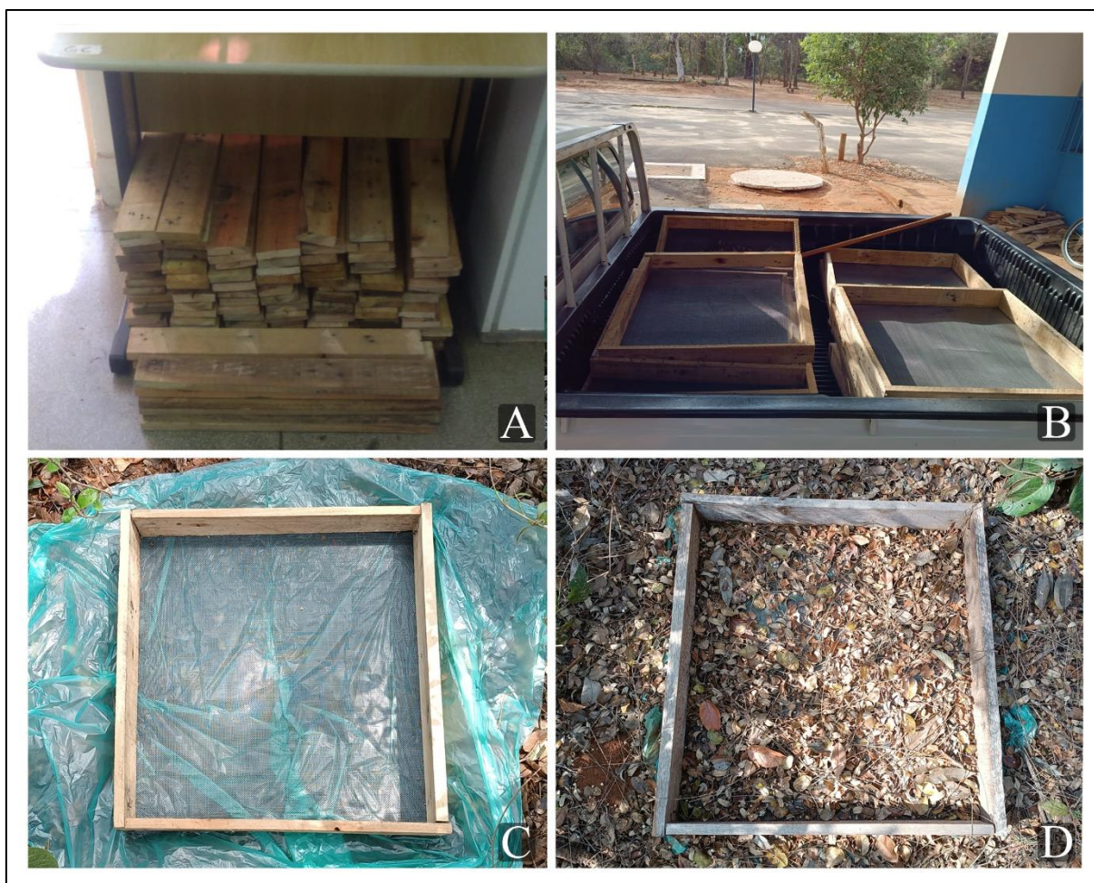
Figura 12. Coletores de aporte da serrapilheira. A) Ripas após tratamento e uniformização; B) Coletores montados e prontos para instalação; C) Coletor instalado; D) Coletor em funcionamento.
