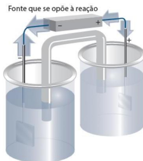
Figura 2 – Esquematização básica da Célula Eletrolítica
