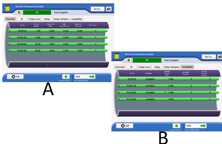
Figura 23 – Resultados detalhados dos testes realizados no equipamento MTS-5800. A) Detalhamento do teste de vazão partindo do sitio remoto Coxim-MS. B) Detalhamento do teste de vazão CINDACTA II.
