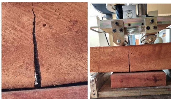
Figura 26 - Ruptura dos prismas de SCAAF.
