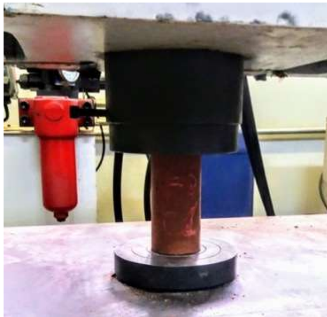
Figura 9 - Ensaio de resistência à compressão simples aplicado no SCAA.
