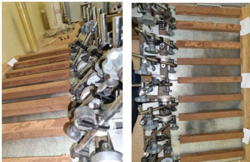
Figura 16 - Instrumentação dos corpos de prova para ensaio variação dimensional nas idades de 1 e 4 dias.
