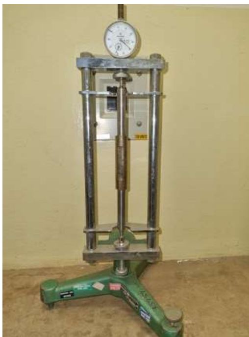
Figura 17 - Calibração do pórtico para ensaio de variação dimensional nas idades de 7 à 28 dias.
