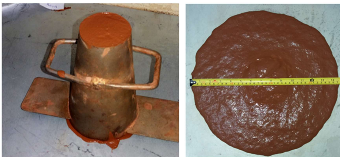
Figura 7 - Ensaio Slump flow modificado aplicado no SCAA.
