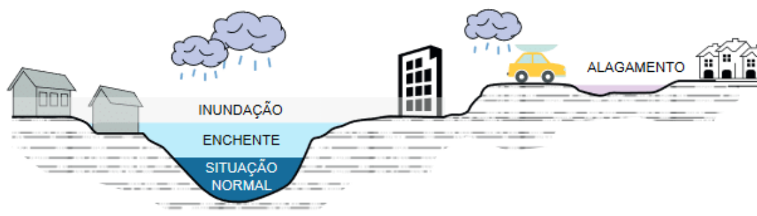
Figura 1: Inundação e alagamento
