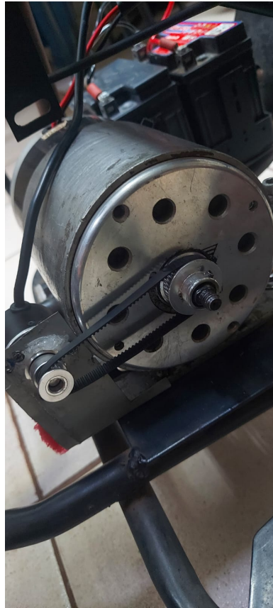
Figura 11 – Fixação do encoder ao lado do motor no robô móvel.
