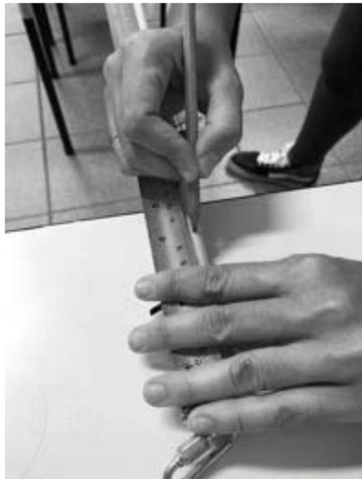
4- Medidas foram marcadas em três pontos para teste de carga. As hastes de madeira variam de tamanho entre 190 cm a 120 cm, com diâmetro de uma polegada aproximadamente.
