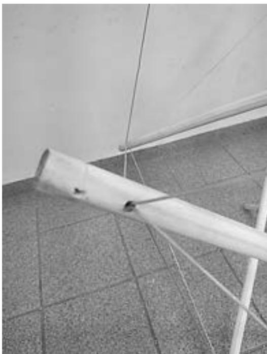
5- Por observar que a estrutura mostraria o rompimento ou fragilidade dos nós com teste de carga, decidimos antes do teste montar o modelo em cabo único, que além de eliminar os elementos de conexão (hastes e cabos), diminui a fragilidade nos nós.
