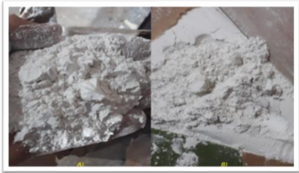
Imagem 4. A) Carga mineral esférica (carbonato de cálcio), B) Carga mineral laminar (talco).
