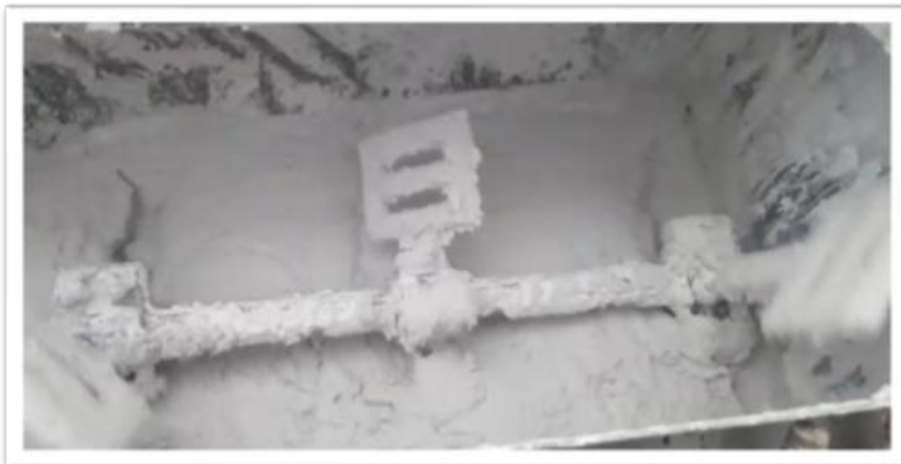
Imagem 9. Tacho com sistema de homogeneização com paletas.
