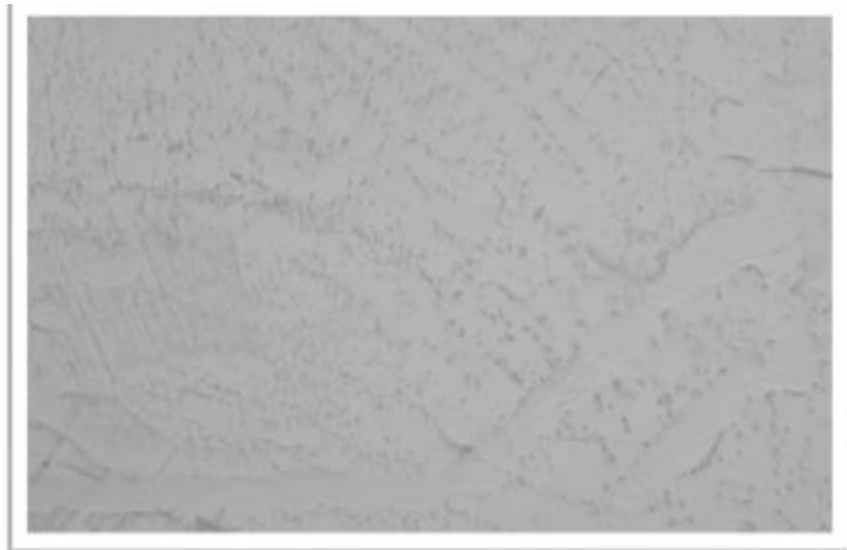
Imagem 18. Teste massa para efeito marmorizado - cargas minerais esféricas.
