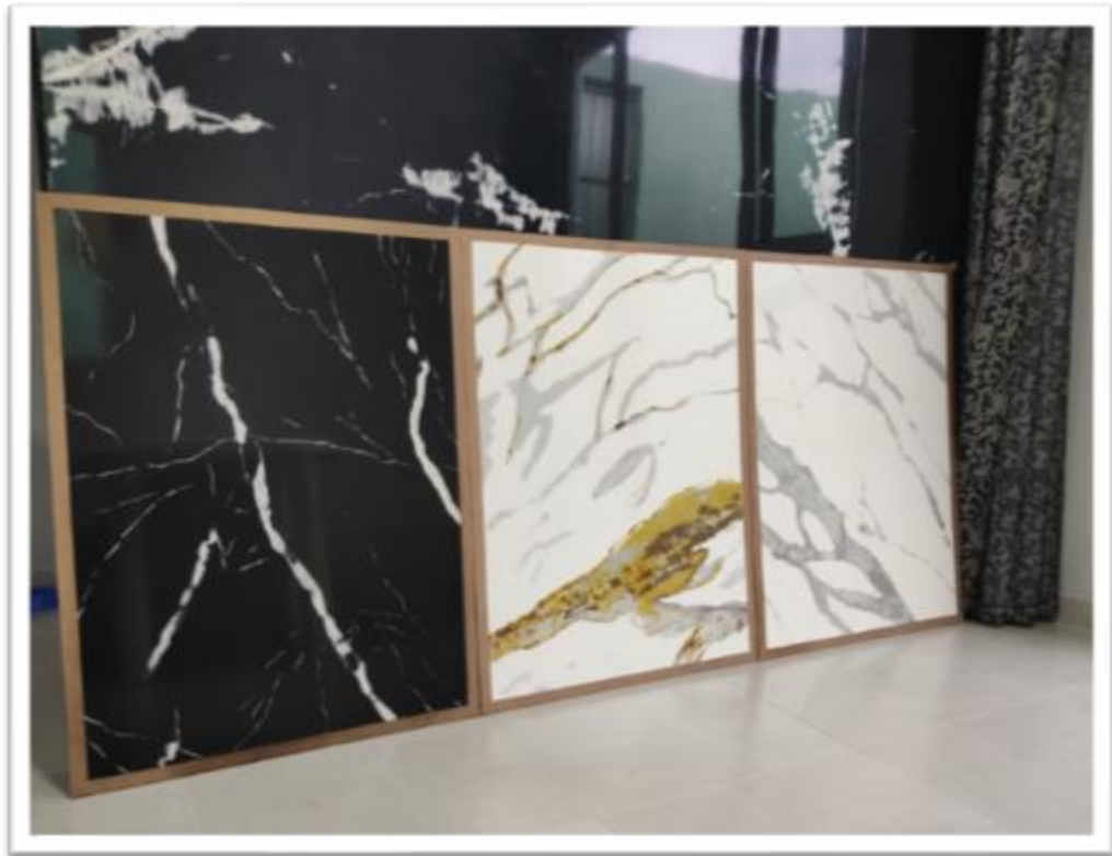
Imagem 19. Teste massa para efeito marmorizado – cargas minerais laminares.
