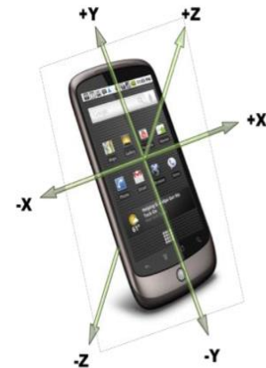
Figura 4 - Eixos das componentes da aceleração de um Smartphone. Fonte: Laboratório Mobilis Computação Móvel
