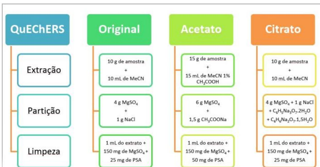
**Figura 5** – Procedimento Experimental da extração via QuEChERS. (ARIAS, et al., 2019).
