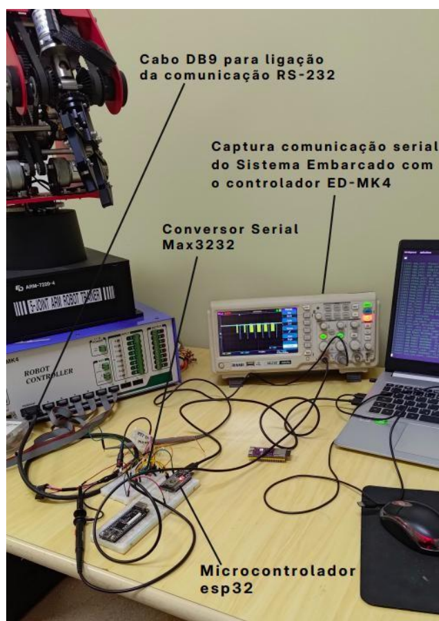
Figura 27: Circuito montado na protoboard para teste
