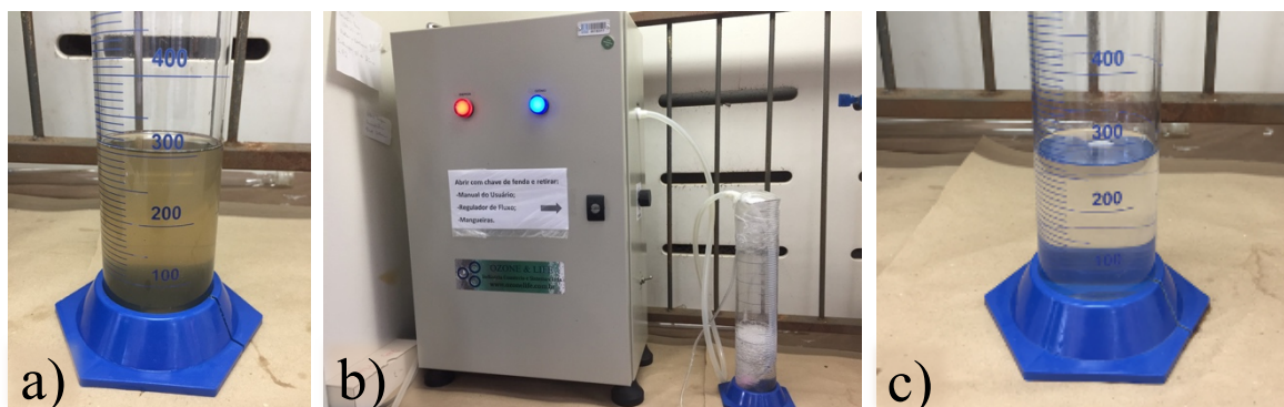
Figura 27. (a) Efluente antes do tratamento. (b) Processo de ozonização e/ou O_3/H_2O_2 (c) Efluente tratado após 30 minutos de experimento.
