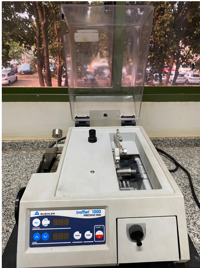
Figura . Cortadora metalográfica de precisão IsoMet 1000, utilizada para cortar os corpos de prova de maneira padronizada.
