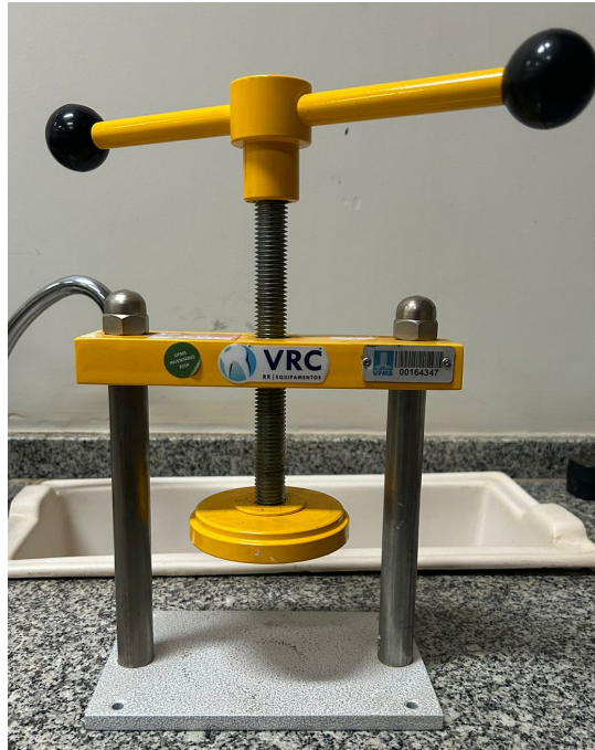
Figura . Prensa hidráulica manual. Utilizada para prensagem da mufla após a inserção da resina em fase plástica.
