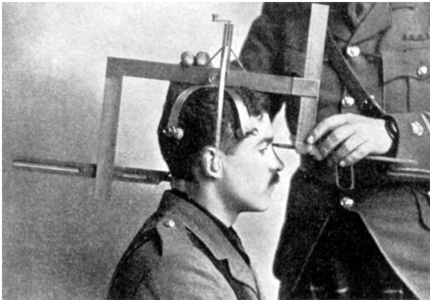
Figura 16: Instrumento antropométrico inventado por Arthur Tremearne e desenvolvido para “a medição de cabeças” e para “o uso de antropólogos”, 1913.
