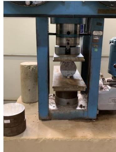
Figura 6 – Ensaio de compressão diametral
