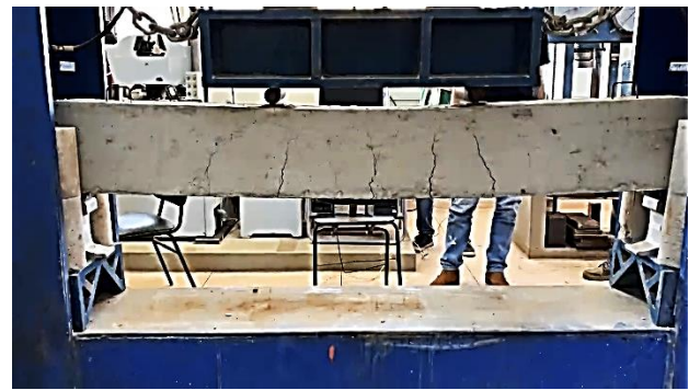
Figura 10 – Rupturas expressivas na viga.
