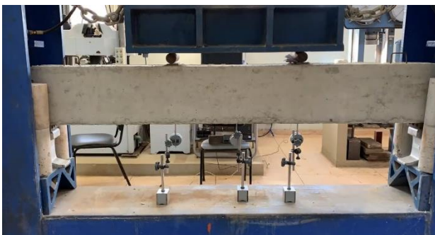
Figura 9 – Viga com relógios medidores de deslocamento.
