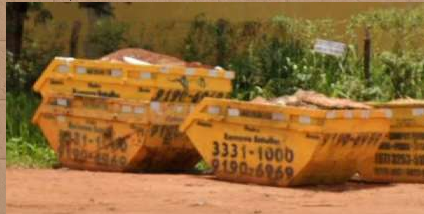
FIGURA 52 - CAÇAMBA DE ENTULHO ESTACIONÁRIA FONTE: AUTORA, 2024
