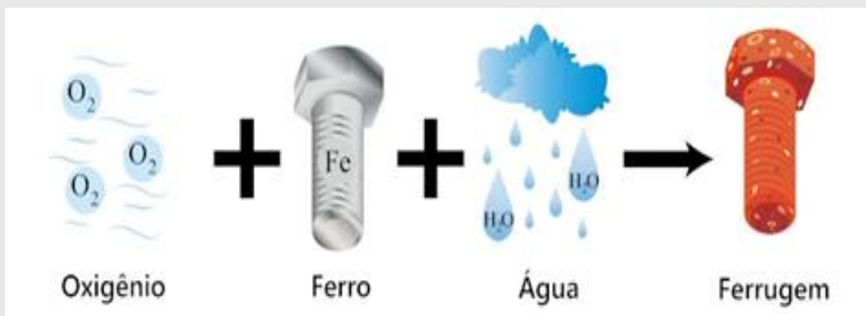
Figura 17: corrosão em meio aquoso
