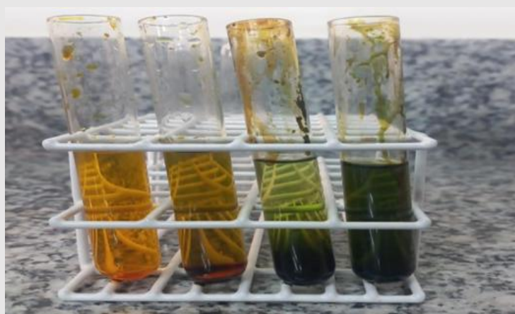
Figura 10: Teste da reação dicromato de potássio com diferentes concentrações de álcool
