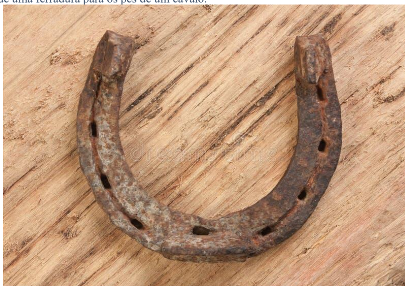
Figura 8: Corrosão de uma ferradura para os pés de um cavalo.
