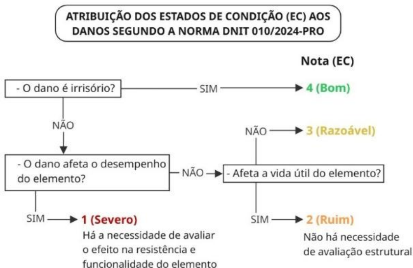
Figura 6 – Atribuição do EC ao dano no elemento segundo a norma DNIT 010/2024-PRO. Fonte: Autora
