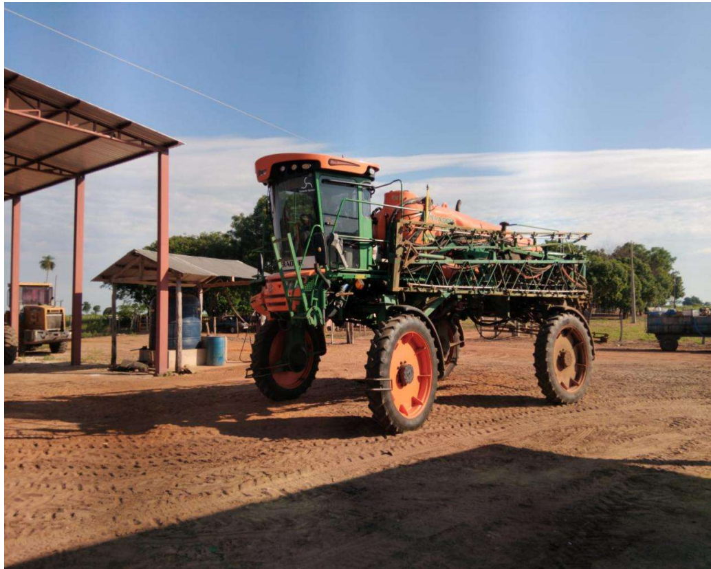
Figura 03. Equipamento conhecido como Gafanhoto, ferramenta utilizada para aplicações de pulverização.
