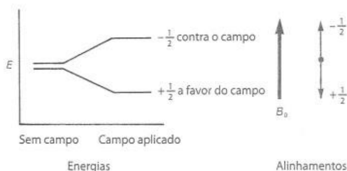
Figura 2: Os estados de spin de um hidrogênio na ausência e na presença de um campo magnético aplicado.
