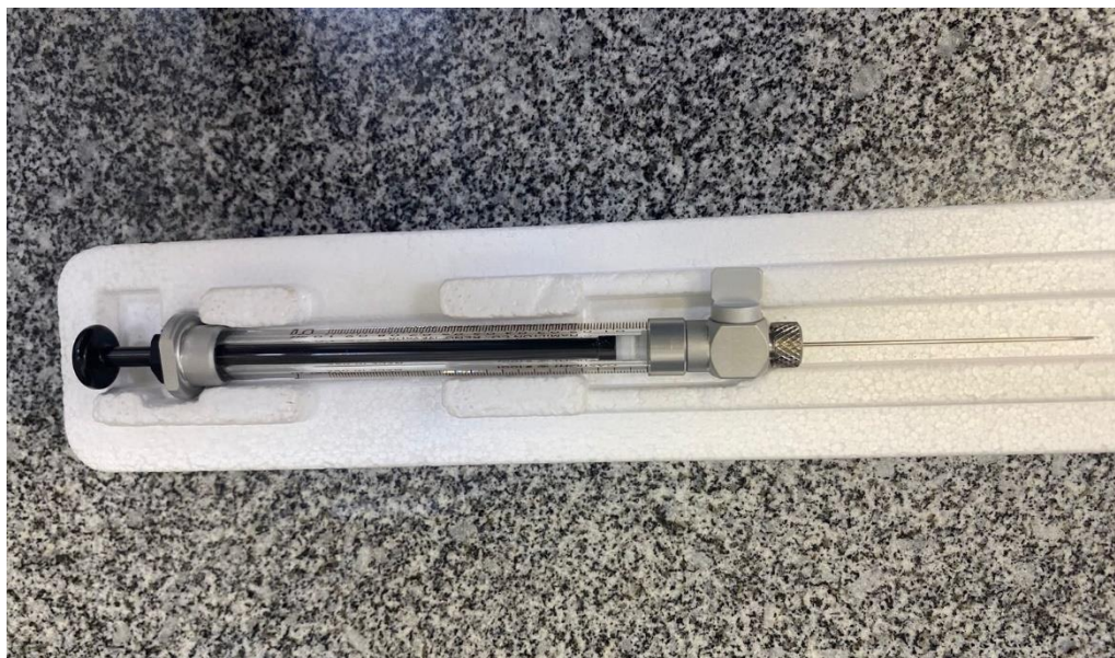
Figura 8: Seringa modelo Hamilton 1 mL, samplelock , utilizada para injeção de amostras no CG-MS. Fonte própria
