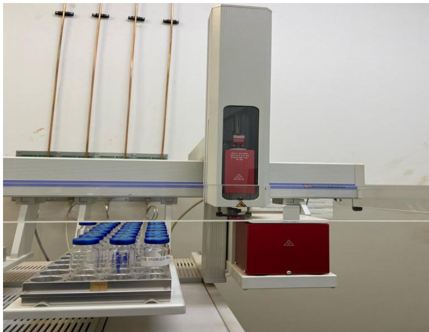
Figura 10: Sistema de injeção de amostras de GC, que possui um forno onde as amostras foram incubadas. Fonte própria
