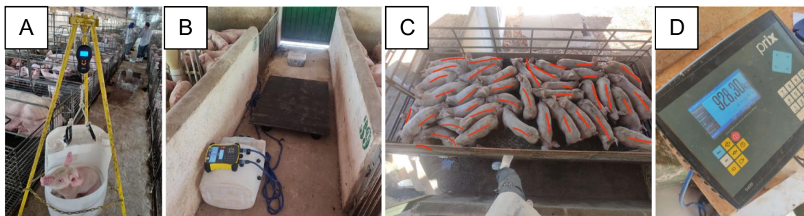
FIGURA 21 – Balanças utilizadas nas pesagens. A: balança digital portátil utilizada até o D14; B: balança de plataforma utilizada a partir do D21; C e D: Balança de plataforma na rampa de embarque/desembarque utilizada no D42 com demonstração da pesagem no visor.
