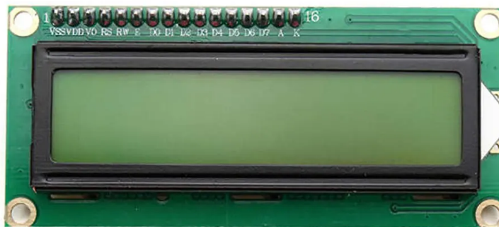
Figura 35. Placa com o LCD JHD162A embutido.
