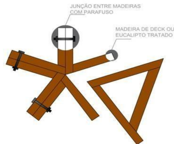
Figura 12: GOODKARMA - Detalhamento do método construtivo dos domos.
