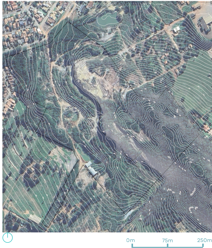
Figura 27. Mapa do levantamento topográfico do relevo original do terreno
