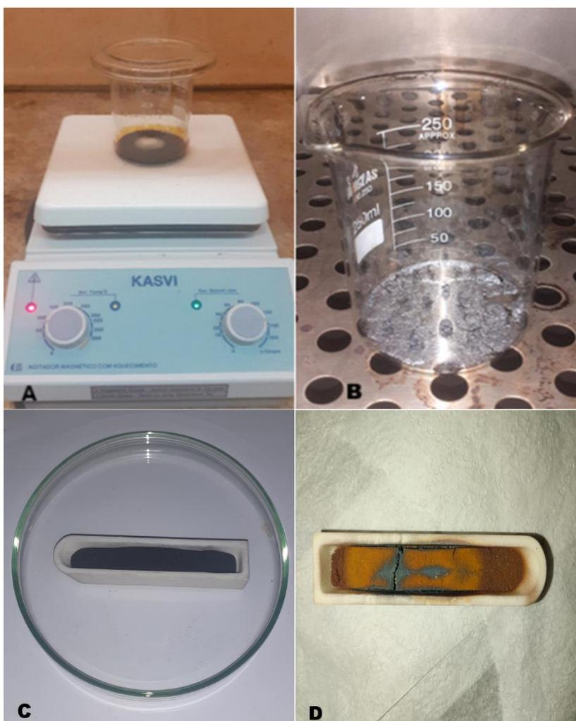
Figura 8 - Início do processo de síntese(a), secagem do composto (b) e processo de calcinação  $\text{FeMnO}_3$  (c,d). Fonte: (Próprio autor).
