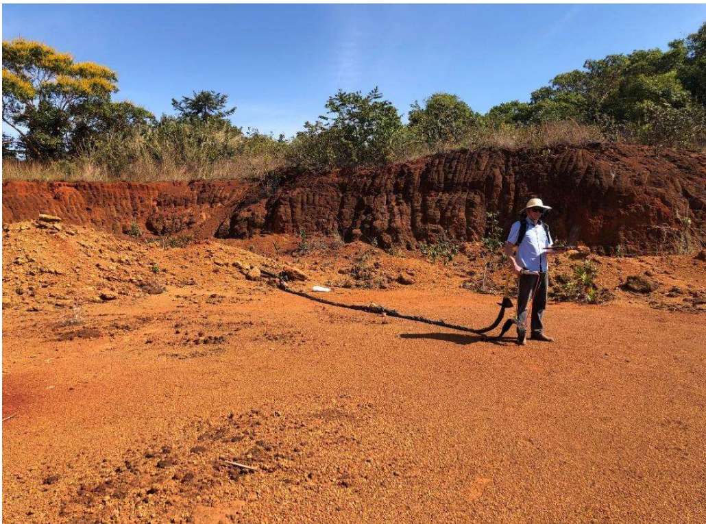
Figura 63. Levantamento com GPR na Pedreira próxima a COOASGO (local da seção Pedreira-1).
