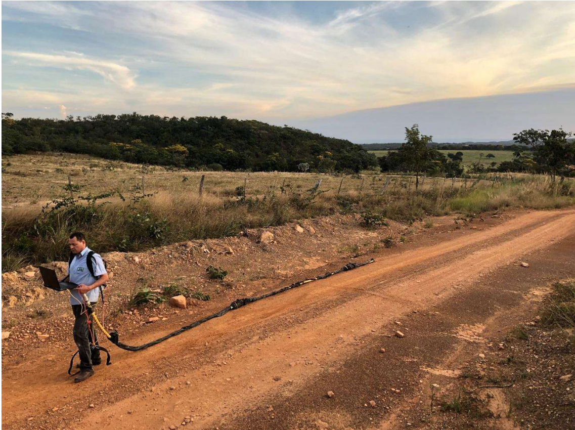
Figura 34. Foto do equipamento Ramac sendo utilizado neste trabalho (antena RTA 50).
