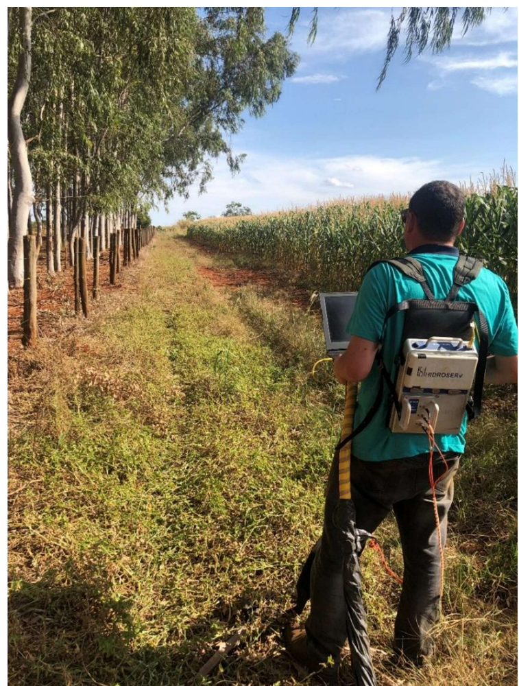
Figura 58. Foto do levantamento com GPR na Pedreira do Aeroporto, mineração de Cangas lateríticas para cascalho.
