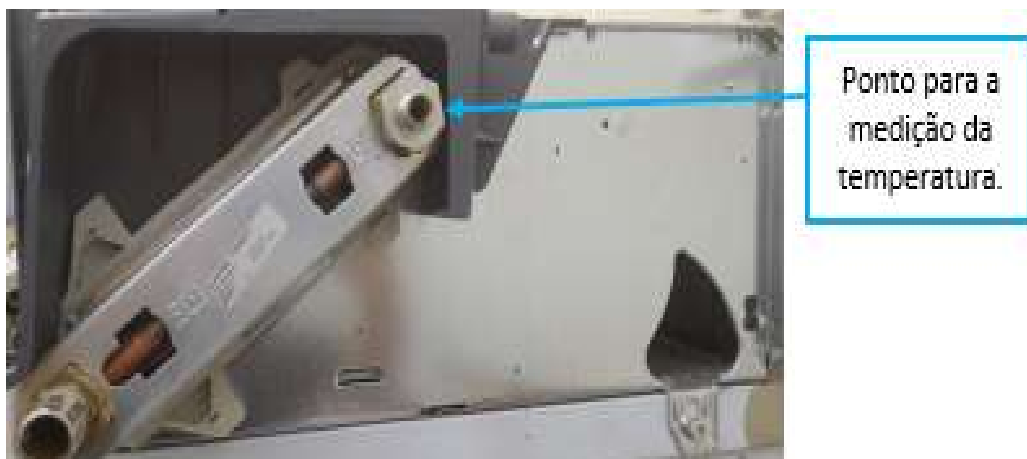
Figura 53. Medição de temperatura da água de entrada no motor
