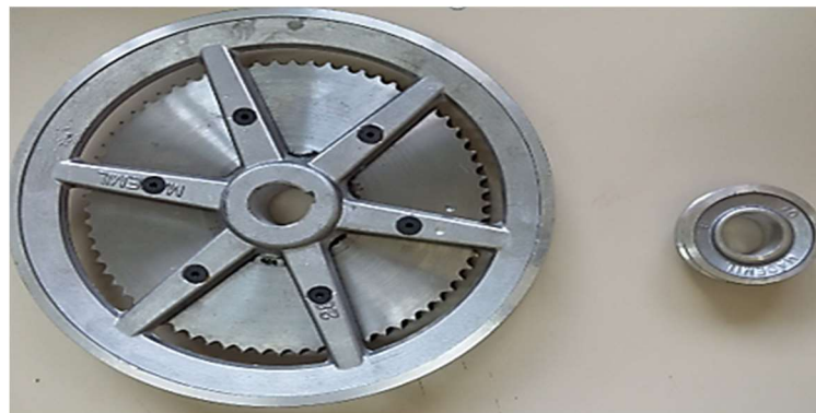
Figura 42. Polia canal B do motor e gerador
