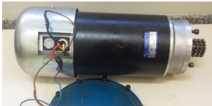
Figura 12. Moto gerador DC
