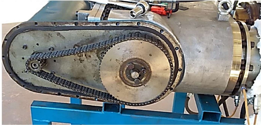
Figura 30. Motor Stirling Genoa 03 sem a tampa de pressurização
