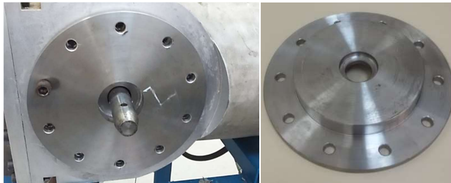
Figura 36. Instalação para teste de medida do flange usinada
