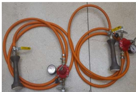
Figura 16. Mangueira para gás GLP, com bico de cerâmica e regular de pressão
