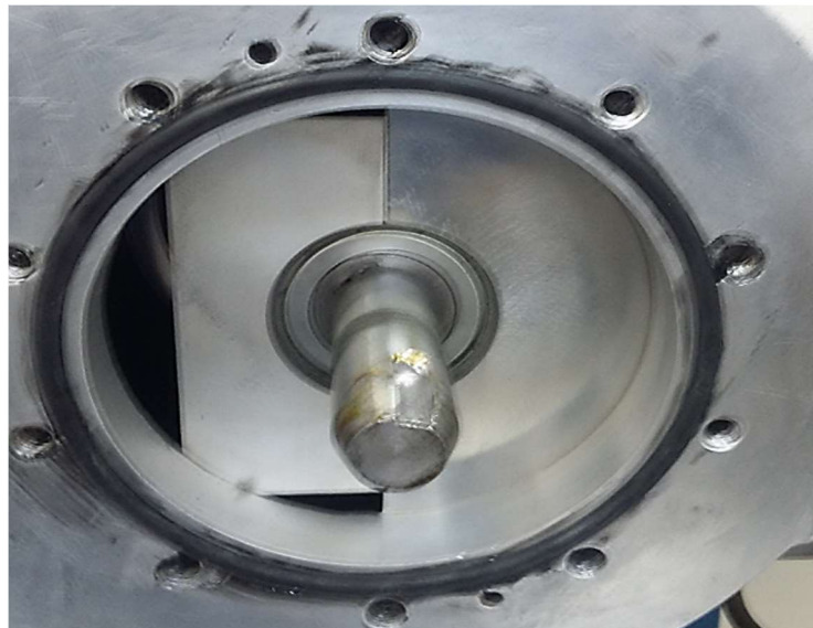
Figura 40. Base do motor Stirling pronta para a instalação da flange
