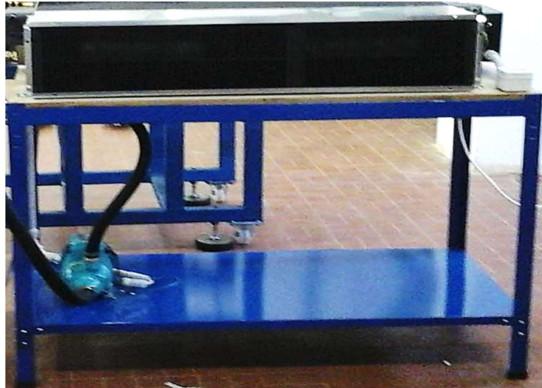
Figura 17. Radiador para refrigeração e bomba de circulação
