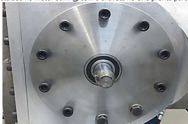
Figura 41. Flange instalada no motor Stirling, com a chave no eixo pronta para a instalação da polia
