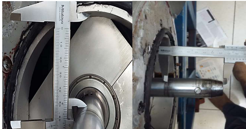
Figura 34. Verificações das medidas para a usinagem
