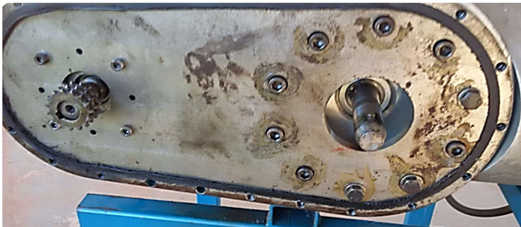
Figura 31. Motor Stirling Genoa 03 sem a corrente e a coroa da transmissão
