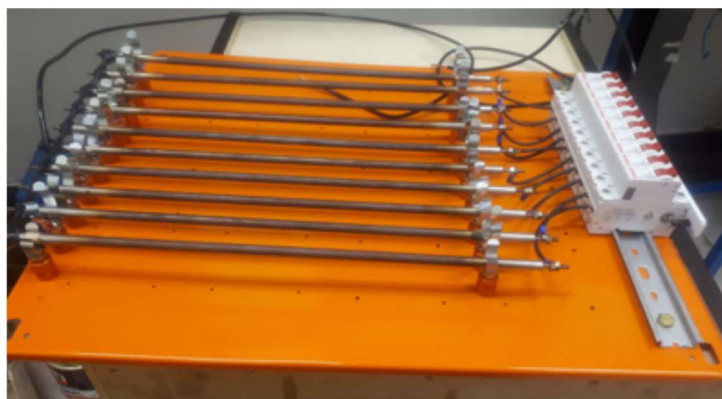
Figura 57. Placa com arranjo de resistências de 47 W
