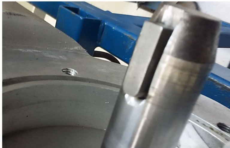
Figura 38. Usinagem do eixo do motor para o uso de chaveta
