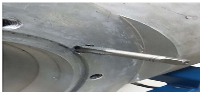
Figura 37. Abertura da rosca do bloco
