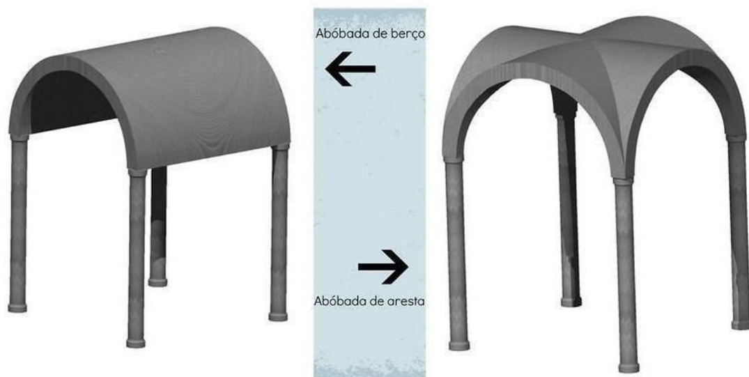
Imag.1 20 - Abóbada de berço e aresta
