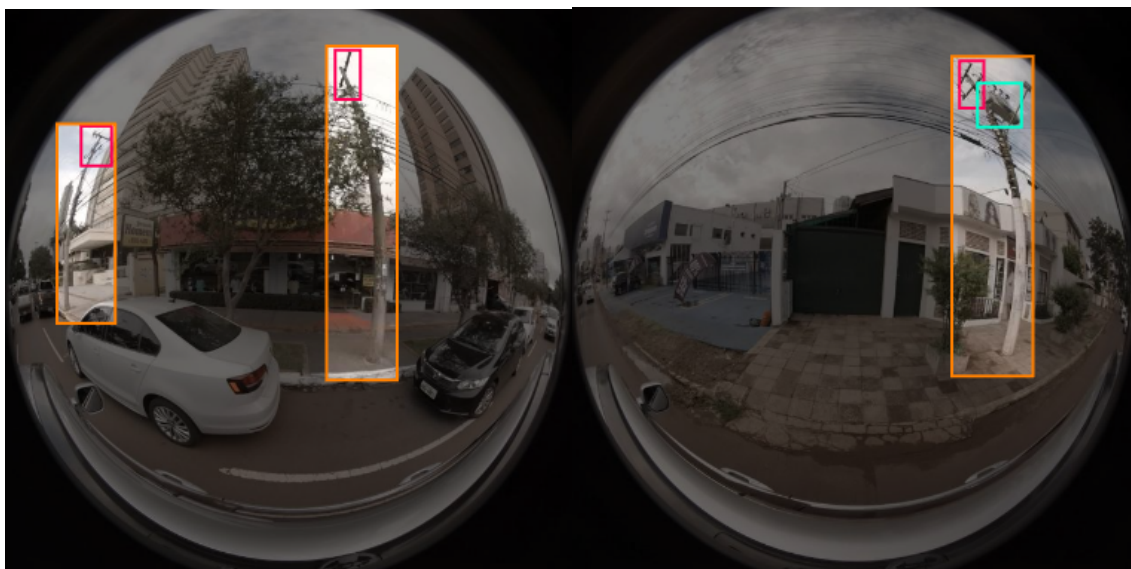
Figure 3. Exemplo de anotação do Poste, Cruzeta e Transformador.
