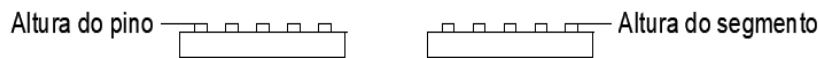
Figura 7 – Representação gráfica em corte dos blocos componentes da sinalização tátil. Fonte: Autor, 2024
