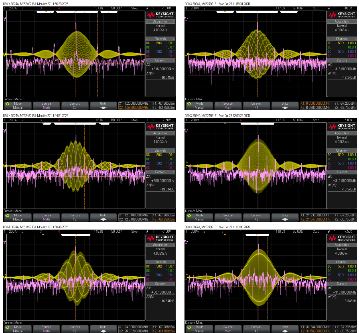
Figura 54: Espectros dos pulsos modulados observados no osciloscópio para os valores de tuning_word de 41, 205, 410, 696, 819, 1024.
