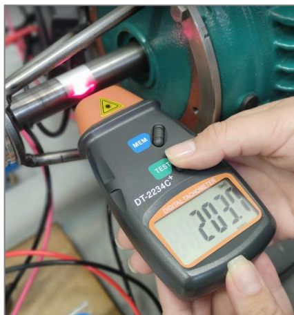
Figura 4. 11 - Medição de velocidade a partir da utilização de tacômetro digital.
