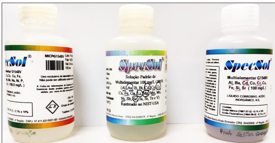
Figura 2. Soluções padrões utilizadas como padrão para obter a curva de calibração.
