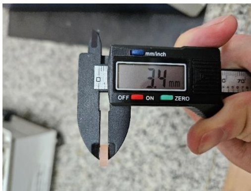
Verificação das dimensões das amostras com paquímetro digital
