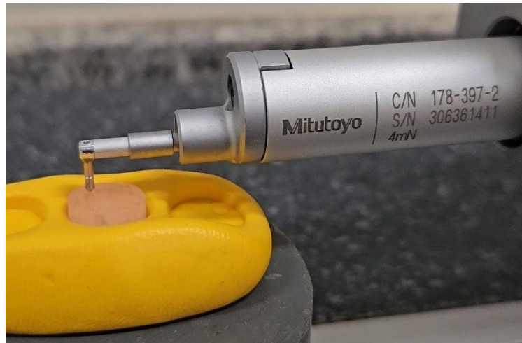
Perfilômetro em processo de leitura do corpo de prova (estabilizado em base de silicone de condensação)
