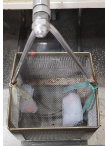
Amostras no interior da cesta apoiada ao braço mecânico da máquina de termociclagem (Cada grupo de resina separada)
