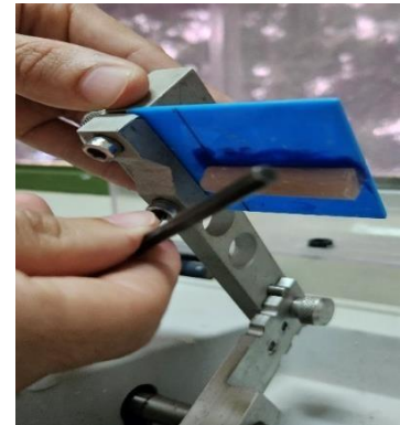
Fixação da base plástica com bastão de poliamida para corte
