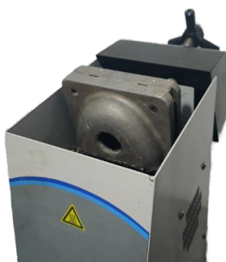
Mufla no forno (com orifício de injeção para baixo)
