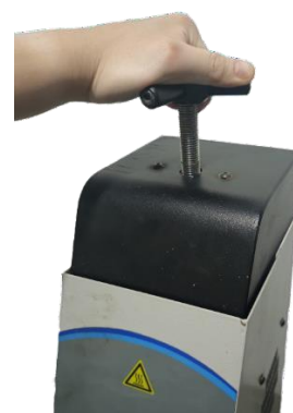
Mufla no forno (com orifício de injeção para baixo)
