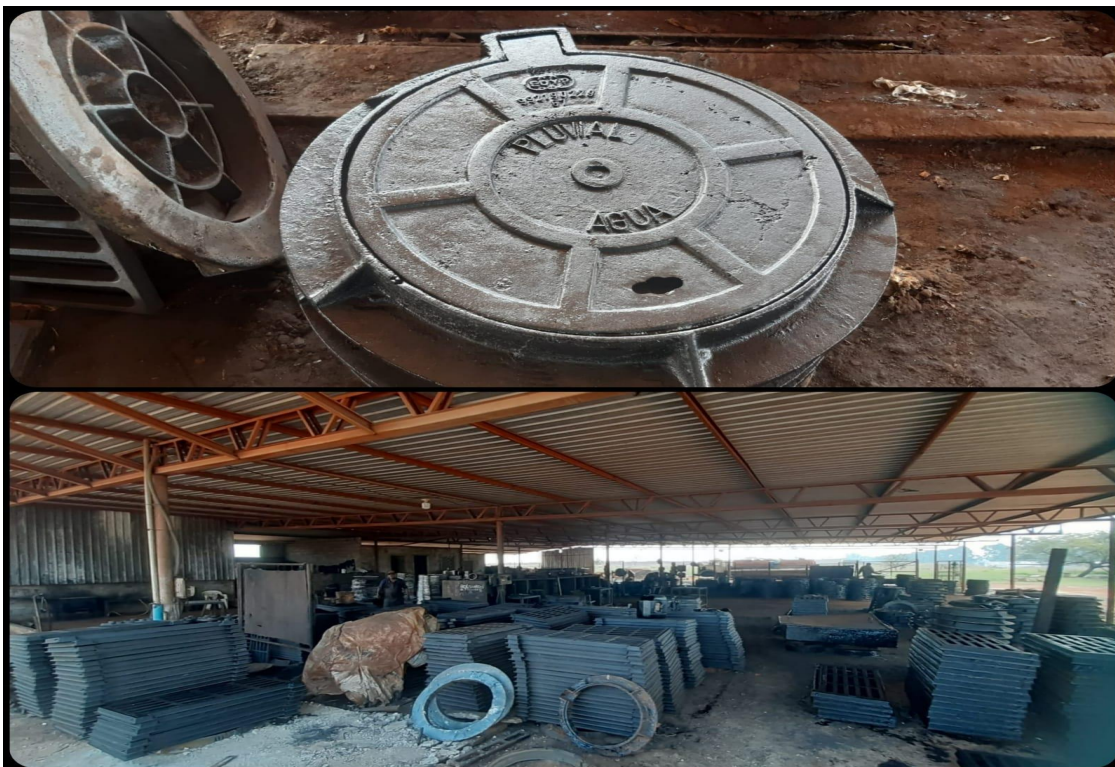
Figura 23 - Produção de Tampas de Esgoto.
