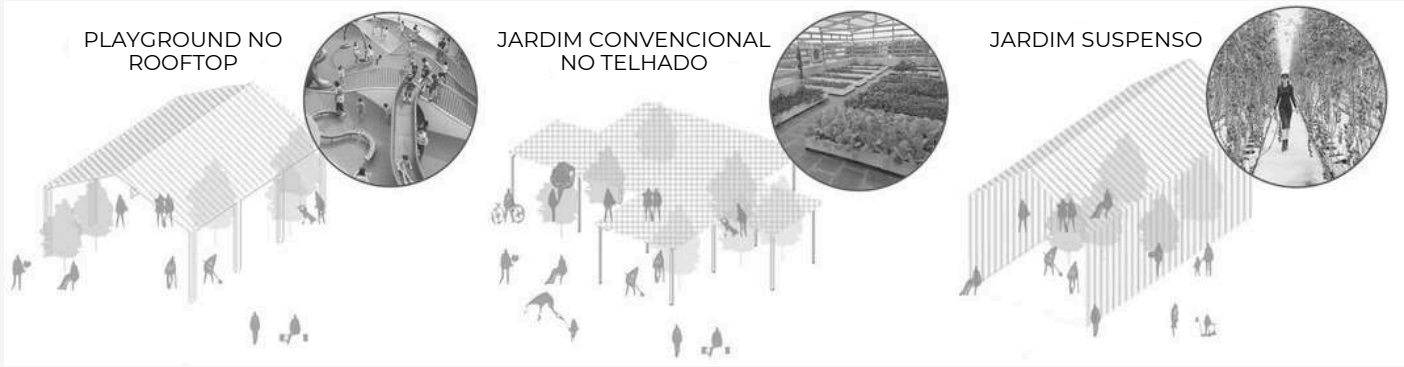
Figura 51. Estrutura metálica para playground e jardins na Escola Infantil Dich Vong Hau. Fonte: Archdaily. s.d.
