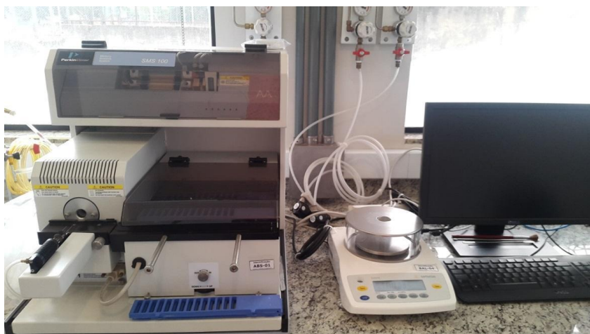
Figura 10: Espectrômetro de absorção atômica especializado em medir a quantidade de mercúrio em amostras sólidas – aparelho SMS 100 da Perkin Elmer.
