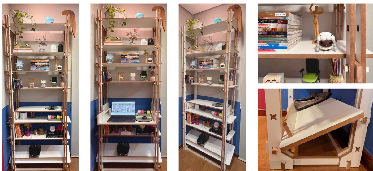
Figura 63 - Estante final fabricada digitalmente em MDF branco 15mm, com CNC Router, na etapa 04
