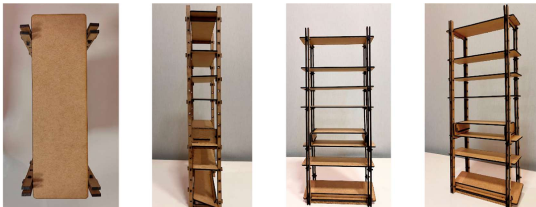
Figura 57 - Protótipo final da estante, cortada a laser em MDF de 3mm, na etapa 03
