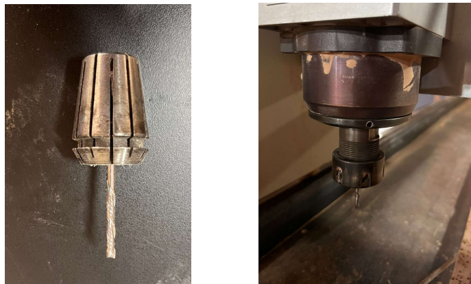
Figura 41 - Fresa no modelo Cutdown, de 0,375mm, utilizada para corte das peças
