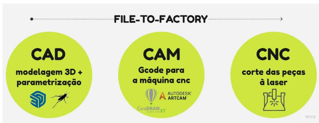
Figura 8 - Diagrama do processo file-to-factory aplicado no desenvolvimento da estante
