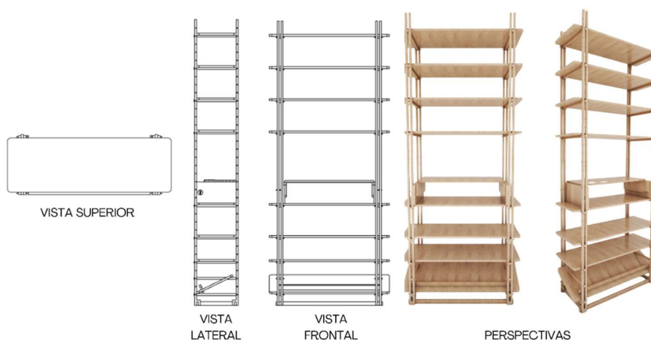
Figura 30 - Vista superior, lateral e frontal da estante
