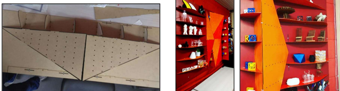
Figura 10 - À esquerda, protótipo de um painel para exposição de objetos e organização de ferramentas. À direita, a peça final, montada em escala 1:1
