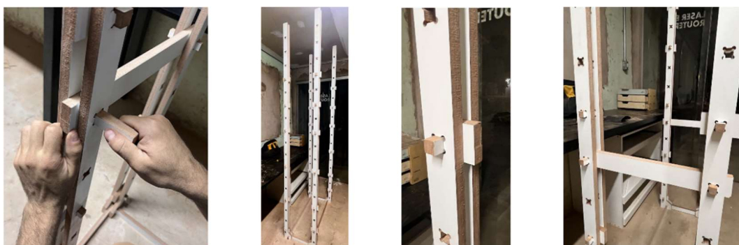
Figura 61 a, b, c, d - Montagem dos suportes, encaixados na base, com a peça de travamento entre eles
