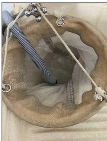
Figura 2- - Filtro utilizado para coleta da água das lavagens
