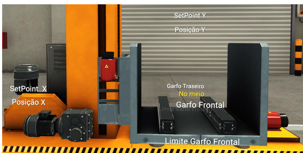
Figura 15 - Detalhes dos eixos e atuadores do Transelevador
