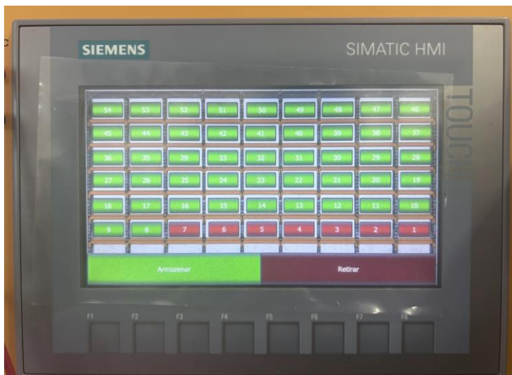
Figura 34 - Interface HMI exibindo status em tempo real
