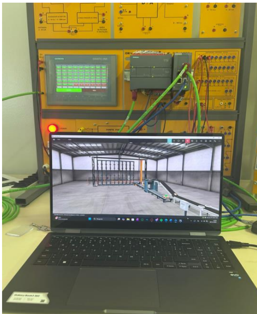
Figura 9 – Setup de validação Hardware-in-the-Loop (HiL)
