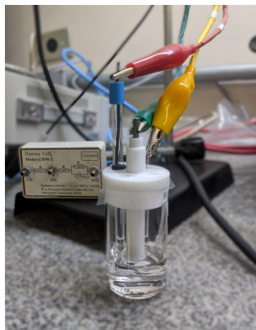
Figura 12: Exemplo de célula eletroquímica com 3 eletrodos. Fonte: autor.
