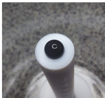
Figura 13: Método de gotejamento para deposição de material no WE. Fonte: autor.
