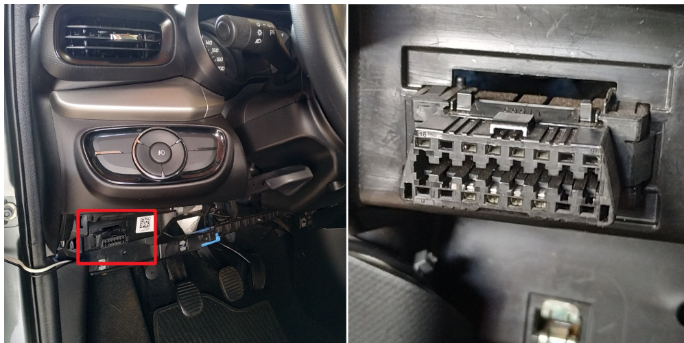
Figura 1 – Posição do conector OBD-II tipo A (esquerda) e vista aproximada (direita).
