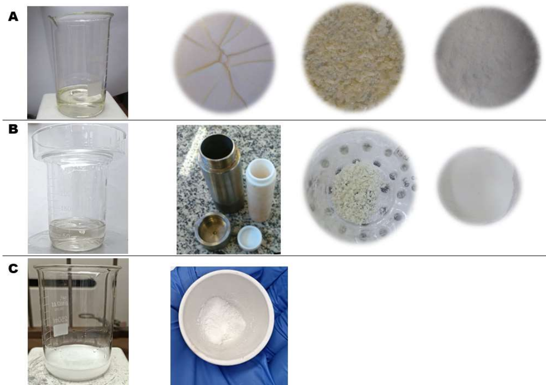
Figura 11. Imagem dos processos e obtenção dos materiais sintetizados: A- \text{TiO}_2 , B- UiO-66 e C- obtenção dos compósitos.
