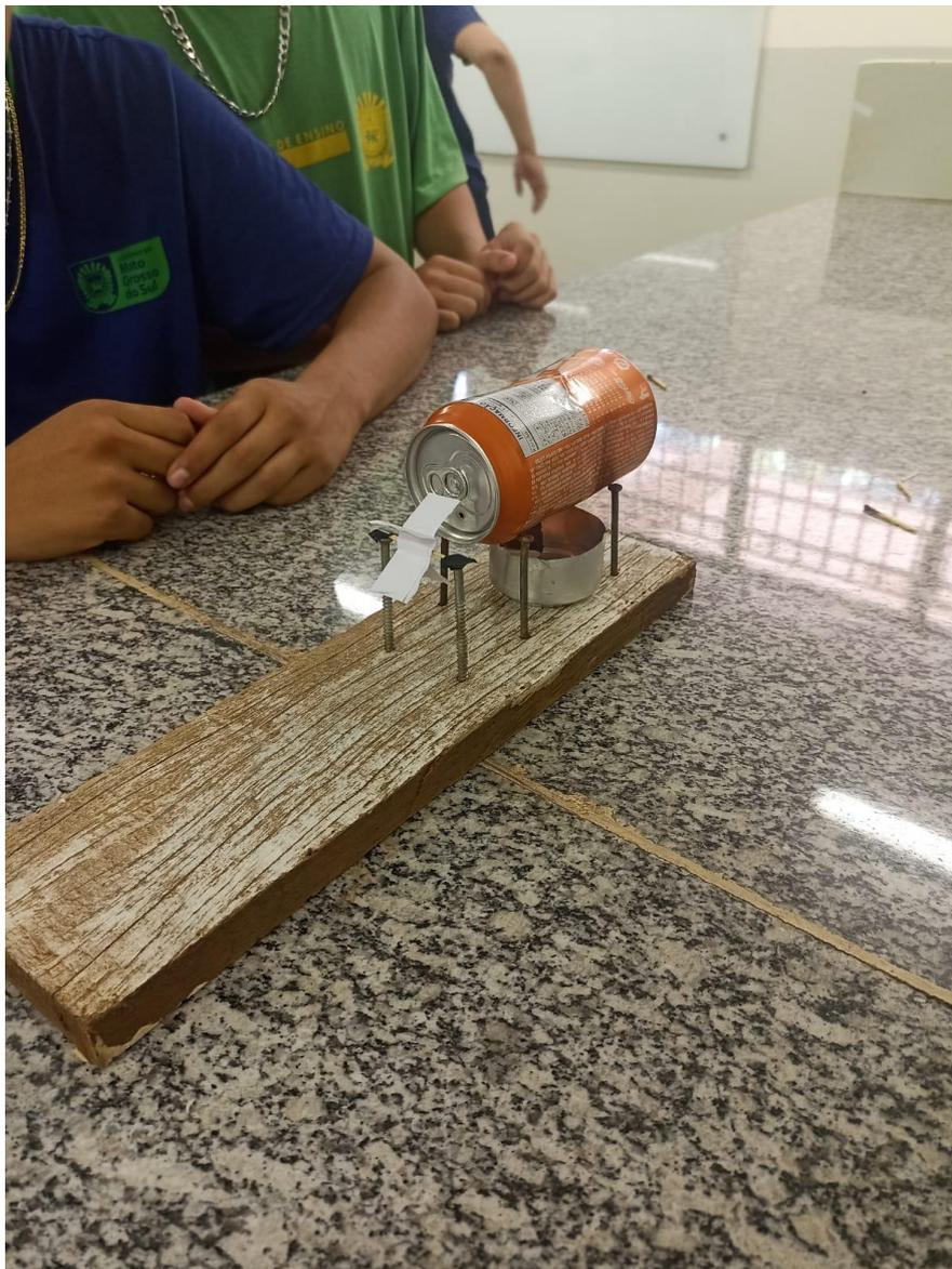
Figura 2 – Experimento montado pelos alunos na aula prática para observação da transformação de energia térmica em energia mecânica.
