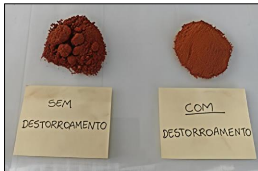
Figura 12 Destorroamento do solo
