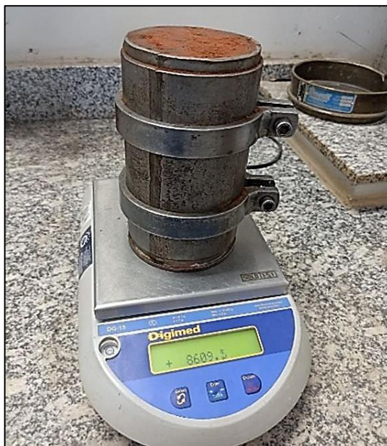
Figura 19 Molde tripartido compactação
