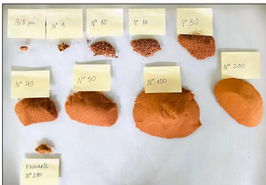
Figura 27 Porções de solo retido por peneira no ensaio de granulometria.
