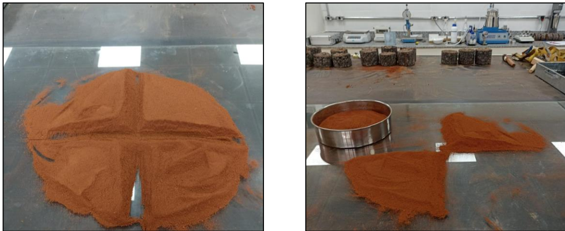
Figura 13 Quarteamento do solo
