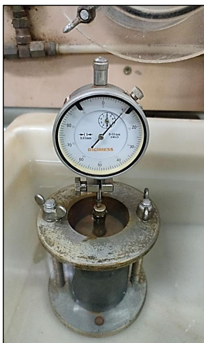
Figura 20 Cp de Mini-CBR imerso
