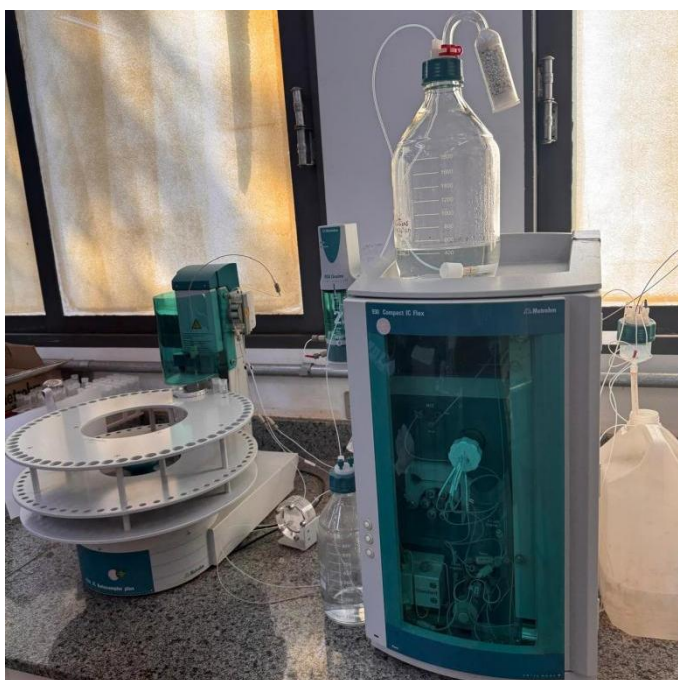
Figura 11. Imagem de um Cromatógrafo de Íons modelo 930 Compact IC Flex 9componente da direita) e um autoinjeter 915 IC autosampler flex (componente da esquerda), ambos da Metrohm. Fonte: do autor.
