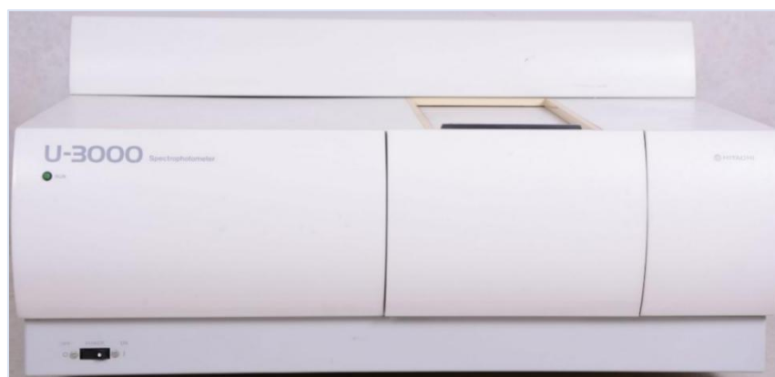
Figura 12. Imagem de um espectrofotômetro UV–visível da Hitachi (modelo U3000).
