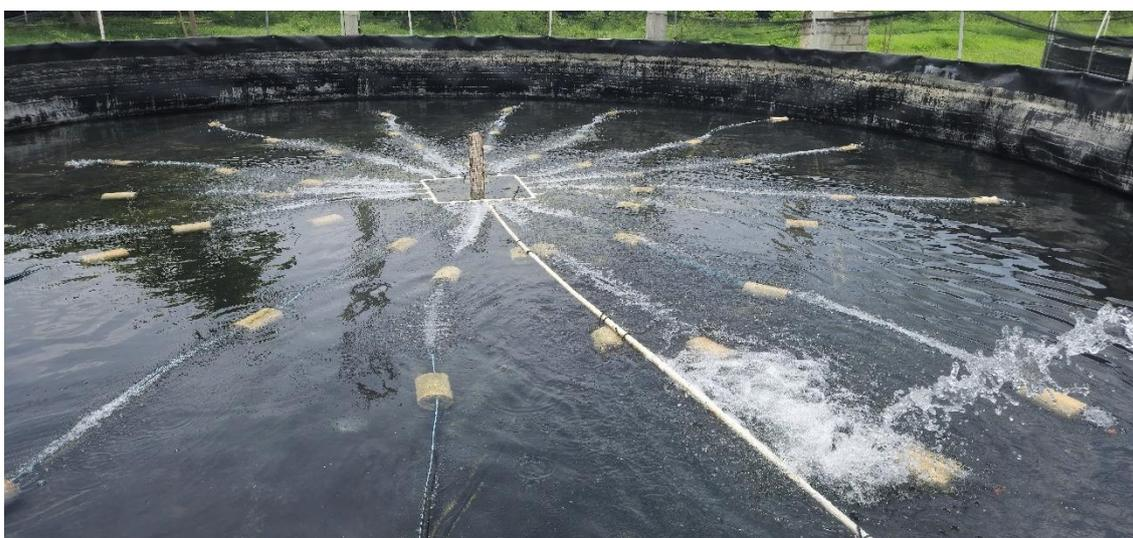
Figura 4. Distribuição das mangueiras de aeração uniformemente em tanque-elevado, antes do início da formação do bioflocos.
