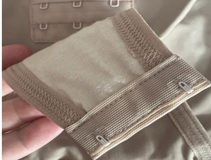
Figura 17 – Peça produzida com colchete sem um dos ganchos
