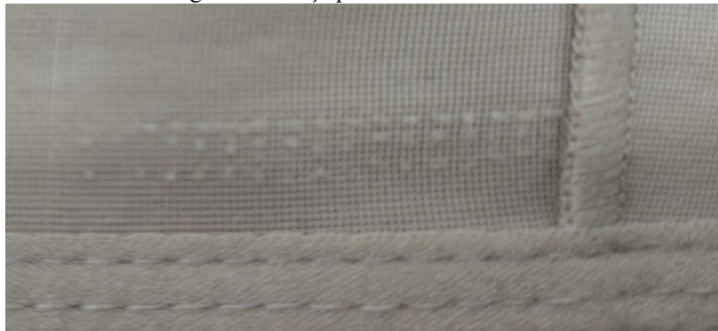
Figura 18 – Peça produzida com tecido danificado
