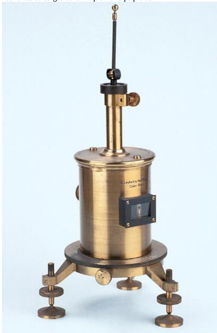
Figura 2 - Eletrômetro de Quadrante ou Dolezalek usado para medir correntes ou cargas de ionização muito pequenas
