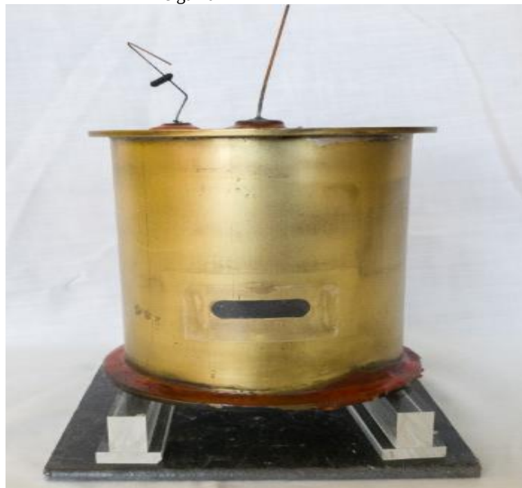
Figura 3 - Eletroscópio de folha de ouro para mensurar as radiações beta e gama
