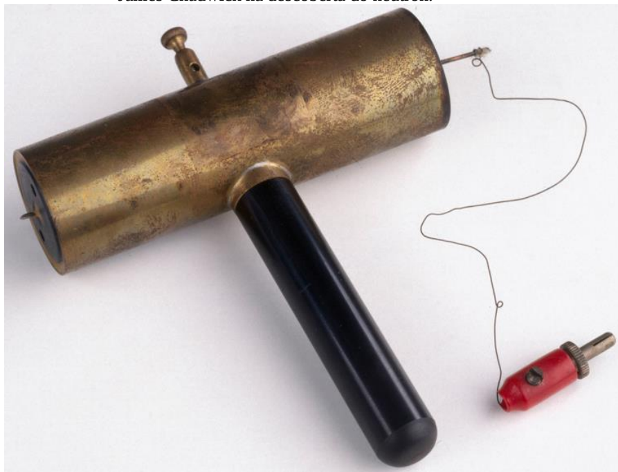
Figura 19 – Dispositivo de radiação antigo feito por Hans Geiger, e em, 1932 foi usado por James Chadwick na descoberta do nêutron.
