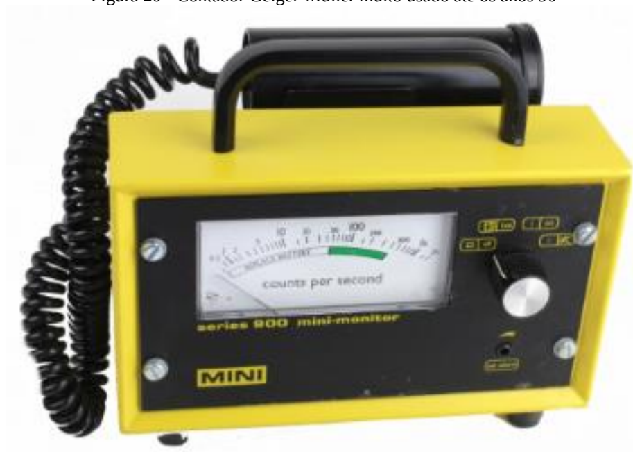
Figura 20 - Contador Geiger-Müller muito usado até os anos 90
